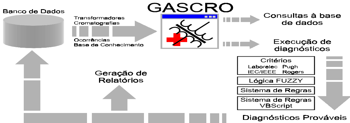
Fig. 7. Estrutura do software GASCRO de diagnóstico preventivo de transformadores de potência.
