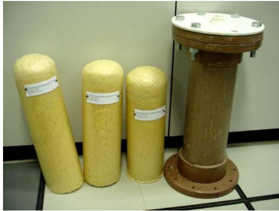
FIGURA 4. Filtros à base de espumas uretânicas sintetizadas no interior do filtro de PVC.
