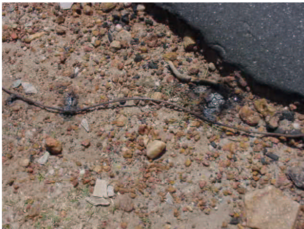
Figura 13 – Detalhe do cabo caído ao lado do asfalto.
