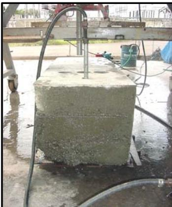
Figura 7 - Ensaio de perda d'água em execução.
