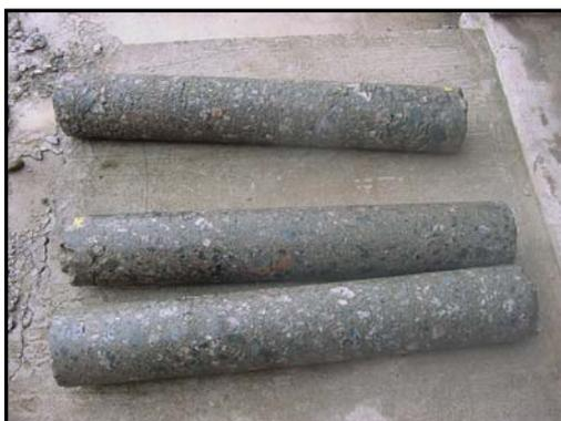
Figura 14 – Aspecto dos testemunhos da pista com GC=96%.
