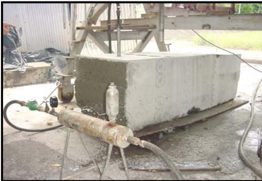
Figura 6 - Acompanhamento ensaio de perda d'água.
