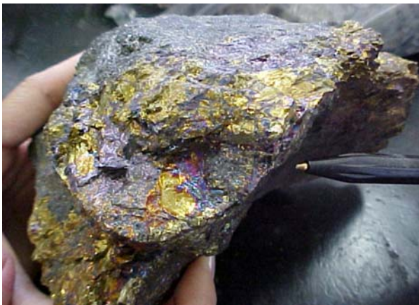
Figura 4: Maciço rochoso contendo sulfetos na forma de pirita, pirrotita e calcopirita (Fonte: FURNAS).
