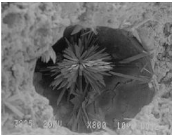
Figura 3: Cristais de gipsita formados em decorrência da alteração do sulfeto de ferro (pirrotita) contido nos agregados utilizados para a preparação dos concretos [5].
