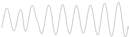
Fig. 2. Onda de corrente filtrada para uma falta monofásica
