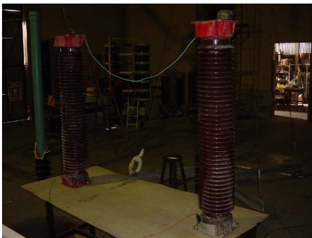
Figura 8 - Para-raios PR4 e PR5 cobertos por poluição salina.
