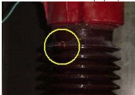
Figura 9 - Descarga superficial em para-raios coberto com poluição salina
