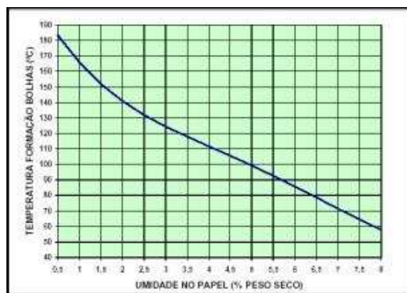
Figura 4 – Umidade x Temperatura de formação de bolhas no óleo.
