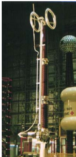
FIGURA 5 – Lâmina de terra com dispositivo especial para manobra de correntes induzidas elevadas sem arco voltaico
