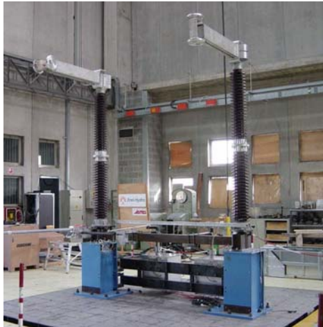
FIGURA 4 – Secionador 245 kV em ensaio sísmico
