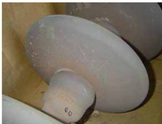
Fotos 3 e 4 – Isoladores usados, expostos por 3 anos com a cobertura, antes dos ensaios elétricos, sem acúmulo ou concentração significativa de poluentes sobre a cobertura avaliada.
