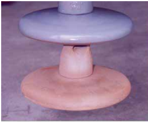
Foto 1 – Isoladores de vidro usados, com e sem a cobertura RTV (superior e inferior, respectivamente).
