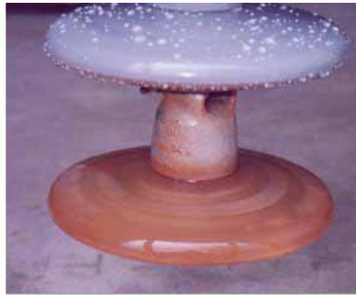
Foto 2 – Isoladores de vidro usados, com e sem a cobertura RTV (superior e inferior, respectivamente), pulverizados com jato d'água.
