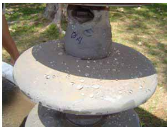
Fotos 7 e 8 – Isoladores usados, com a cobertura RTV, mantendo a hidrofobicidade, após 3 anos de exposição e realização de novos ensaios (LD Fosfertil-Uberaba5 - 138 kV).
