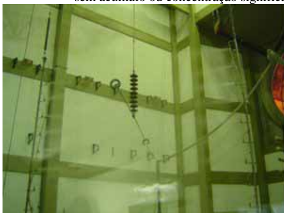
Fotos 5 e 6 – Ensaio de suportabilidade elétrica sob névoa limpa ou salina, no início da formação da névoa e próximo da sua estabilização, necessária ao ensaio.
