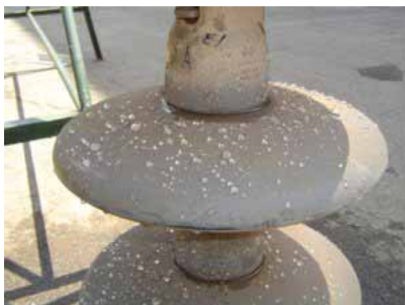
Fotos 7 e 8 – Isoladores usados, com a cobertura RTV, mantendo a hidrofobicidade, após 3 anos de exposição e realização de novos ensaios (LD Fosfertil-Uberaba5 - 138 kV).
