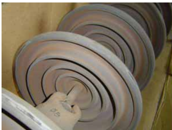
Fotos 3 e 4 – Isoladores usados, expostos por 3 anos com a cobertura, antes dos ensaios elétricos, sem acúmulo ou concentração significativa de poluentes sobre a cobertura avaliada.
