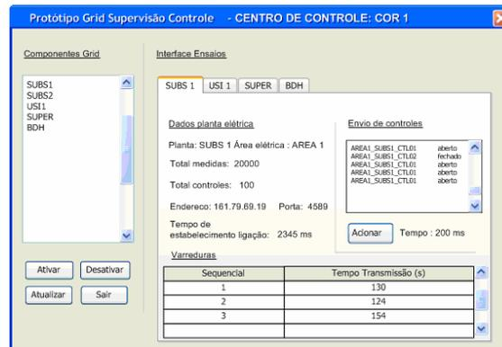
FIGURA 5: Interface do centro de controle para ligação de supervisão e controle
