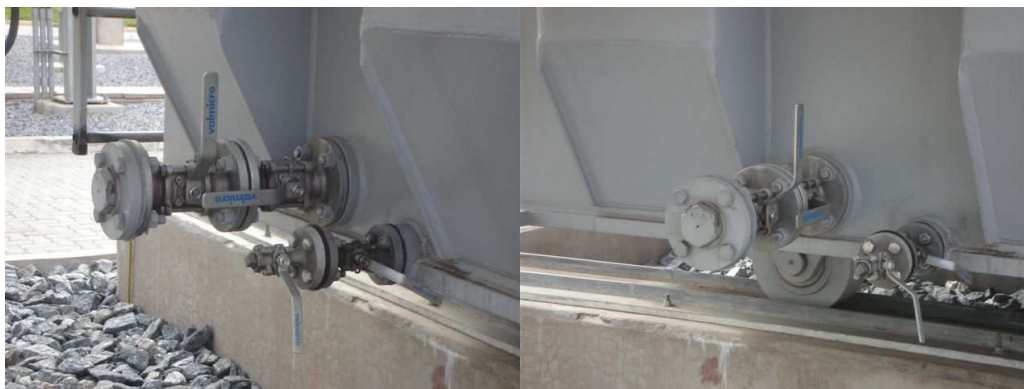
Fotos 7 e 8 – Detalhe das válvulas tipo esfera ligadas em série
