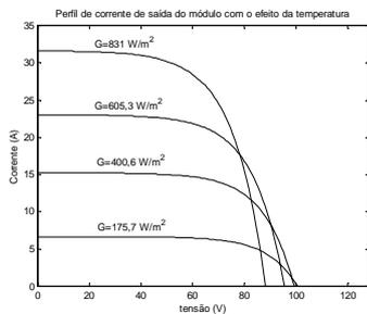
FIGURA 5 – Curva da corrente dos módulos
