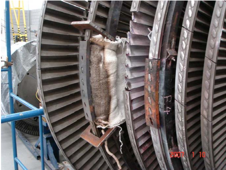
Figura 3 – Recomposição por soldagem das cabeças dos rebites das palhetas
