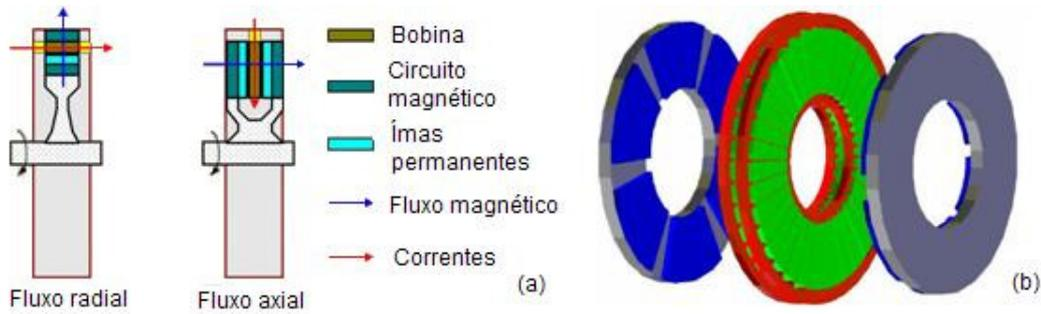
FIGURA 3 – Orientações de fluxo (a) e máquina de fluxo axial com duplo rotor (b)
