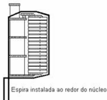
Figura 1 – Espira envolvendo núcleo e carcaça
