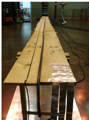
FIGURA 1 – Bancada de Ensaios com condutor gerador de distúrbio e condutor a ser ensaiado
