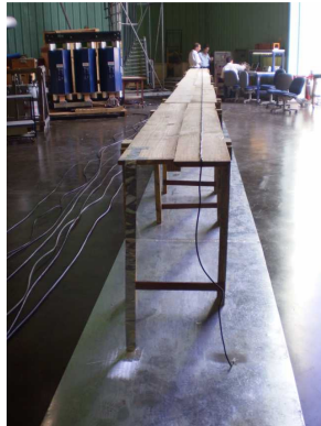
FIGURA 2 – Bancada de Ensaios sobre o plano terra
