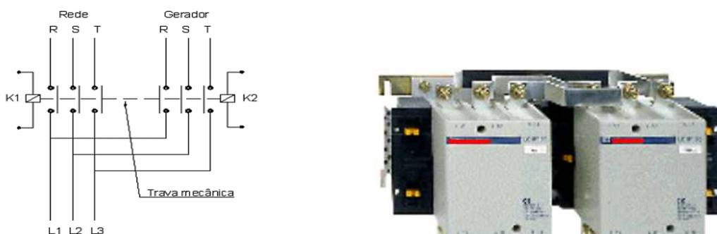
Figura 3 – Diagrama de Transferência de Fontes a Contatores (11)
