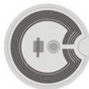
Figura 4 – Tag RFID que fica inserido no interior da Lingueta de contato.
