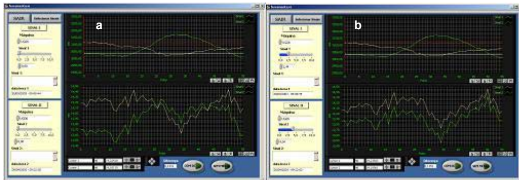
Figura 2 – Sinais de entreferro originais (a) e corrigido (b).
