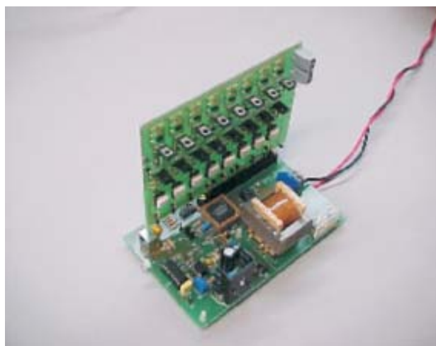
FIGURA 6. Foto do circuito subdimensionado.
