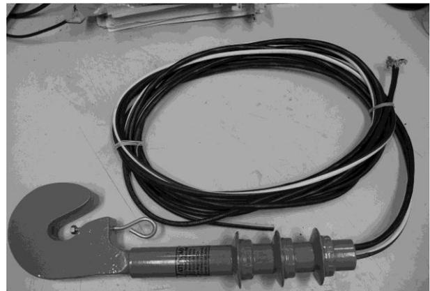
Figura 4. Foto do sensor de voltagem e corrente construído.
