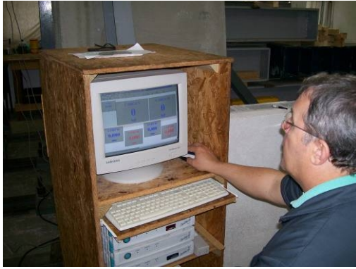
Figura 10. Monitoramento dos sinais das células de carga e dos LVDTs.
