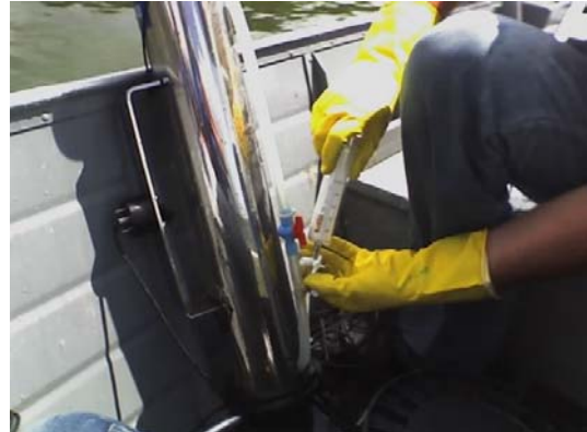
FIGURA 4 – Retirada da amostra de água da garrafa coletora de Van Dorn com a seringa de vidro.
