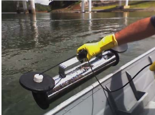
FIGURA 3 – Garrafa coletora de Van Dorn.
