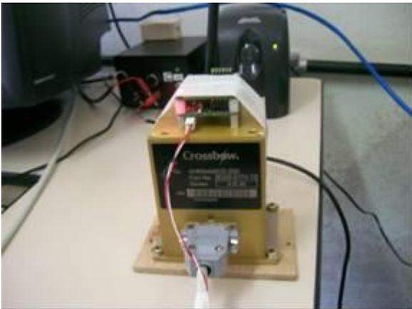
Figura 5. Plataformas Crossbow e Sparkfun fixadas para calibração.
