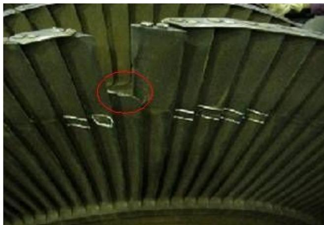
Figura 1. Estágio onde ocorreu fratura e trincamento de palhetas, salientando os detalhes da palheta fraturada no círculo vermelho.
