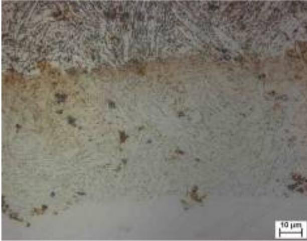
Figura 13. Corpo de prova (AISI 403) após teste potenciodinâmico em solução de NaCl 25%, aumento de 1000x.
