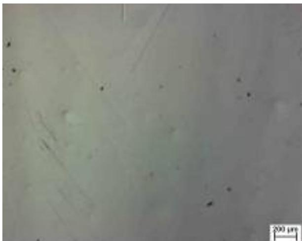
Figura 15. Corpo de prova (AISI 403) após teste potenciodinâmico em solução de NaOH 40%, aumento de 100x.
