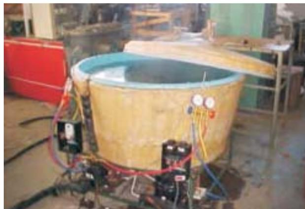
FIGURA 1 - O reservatório de água quente e medidores de temperatura e pressão – versão experimental.
