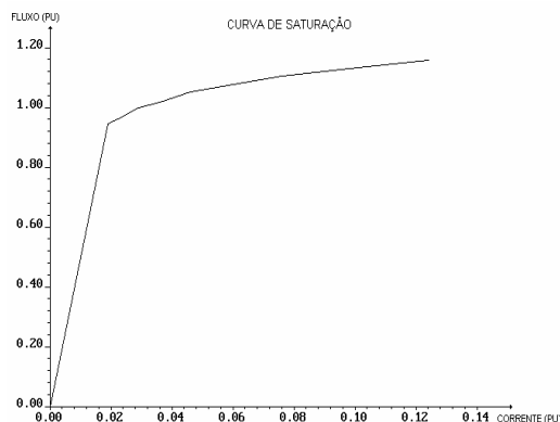
Figura 17 - Curva de saturação típica do transformador
