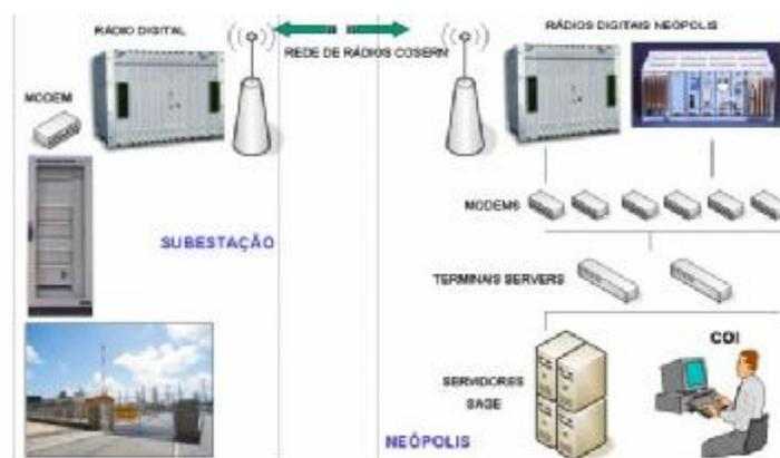
Figura 2-Arquitetura de comunicação entre a Subestação e Centro de Operação.
