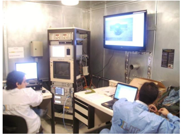
Figura 20 - Engenheiros do INPE e da equipe do projeto aplicando o teste no equipamento rastreador.
