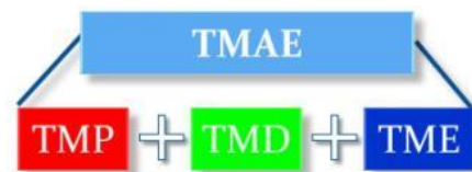
Figura 1 – Composição do TMAE (Tempo Médio de Atendimento a Ocorrências Emergenciais), onde: TMP é o Tempo Médio de Preparação da equipe, TMD é o Tempo Médio de Deslocamento e TME é o Tempo Médio de Execução do serviço.
