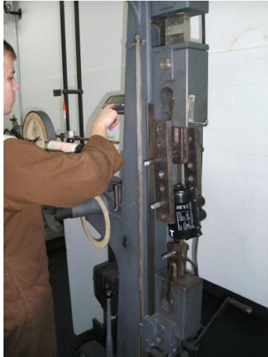
Figura 18 - Teste de tração com o equipamento rastreador de faltas.
