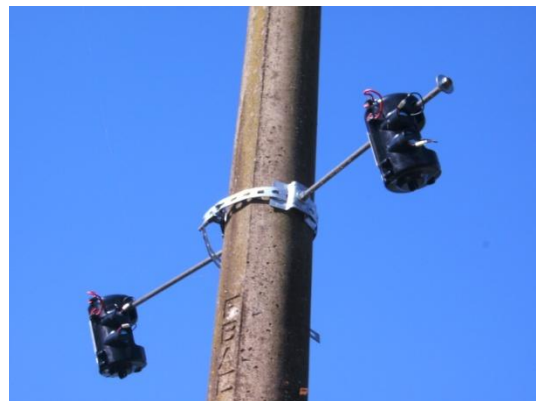
Figura 5 - Sistema de comunicação operando em 433 MHz e 915 MHz.
