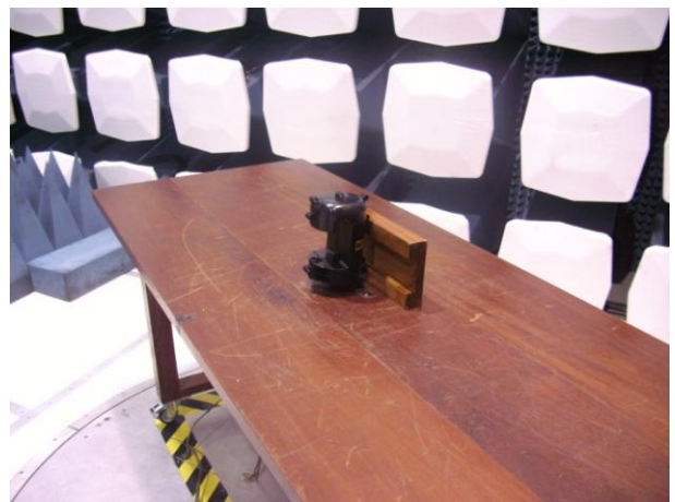
Figura 21 - detalhe do rastreador posicionado na câmara anecóica do INPE para o ensaio segundo a resolução 506 da ANATEL.
