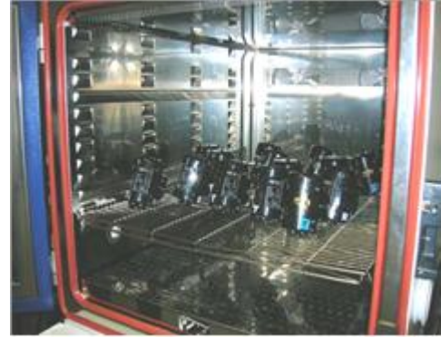
Figura 16 - Equipamentos posicionados na estufa para aplicação dos ensaios de ciclagem térmica.
