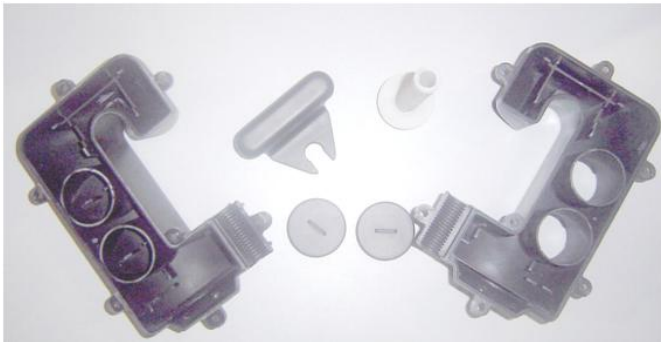
Figura 12 - Protótipos de todas as peças do gabinete plástico fabricadas pelo processo de prototipagem através de injeção em molde de silicone.
