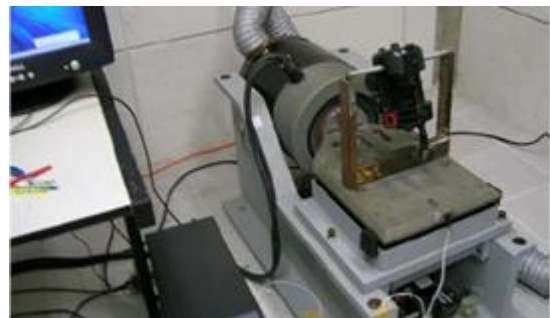
Figura 17 - Mesa Vibratória para testes com o rastreador de faltas.
