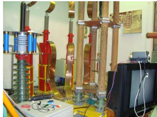
Figura 7. Ilustração da estrutura do laboratório para ensaios de transitórios impulsivos.
