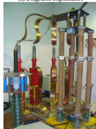
Figura 26. Arranjo laboratorial para o ensaio de impulso visando avaliar o desempenho do DPS.
