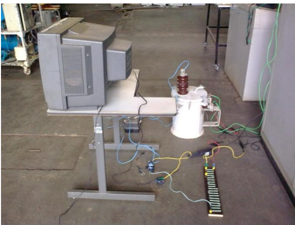
Figura 5. Detalhes da montagem laboratorial – ensaio de um televisor usado 20 polegadas.
