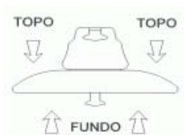
FIGURA 3. Identificação das partes do isolador de disco.
