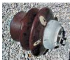
(c) – Danos em isoladores por descarga após 3 dias de névoa
