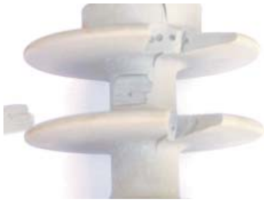
FIGURA 1 - Vista do isolador de ancoragem onde são observados vazios internos.
