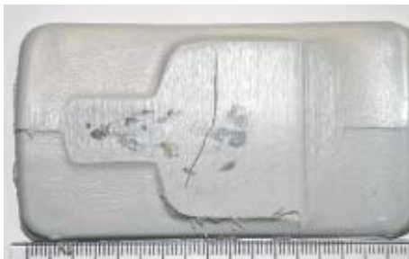
FIGURA 3 - Vista de parte do espaçador apresentando inhomogeneidades no material da peça.
