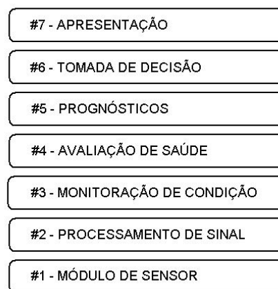
Figura 1. Arquitetura OSA-CBM e suas 7 camadas.
