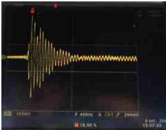
Figura 7. Corrente medida com TC de alta frequência aplicado ao condutor de aterramento do pára-raios da fase BRANCA (escalas 100mV/div e 400ns/div).
