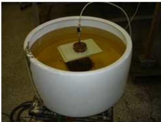
Figura 1. Placa de poliéster imersa em óleo isolante, contendo uma cavidade, posicionada entre dois eletrodos de latão.
