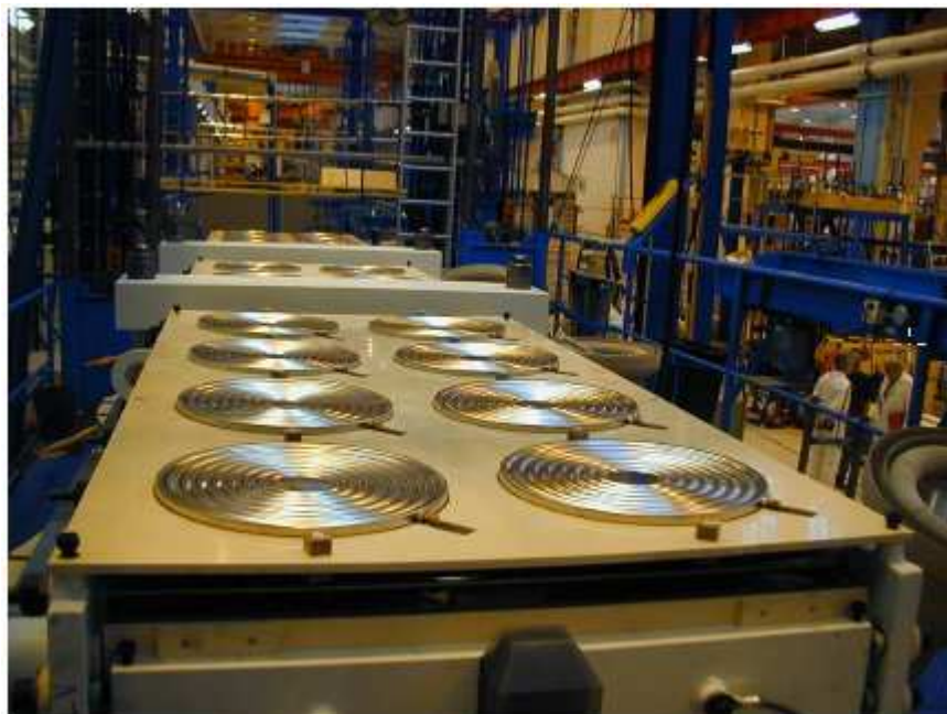
Figura 5 Membranas de absorção montadas em um reator de 150 MVAR
