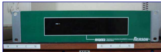
FIGURA 6 – Indicador Automático de Qualidade de Energia Elétrica. Evolução do modelo de montagem externa ao painel da SE, para modelo tipo RACK, e da fonte de alimentação CC, para CC/CA com comunicação celular ou servidora.
