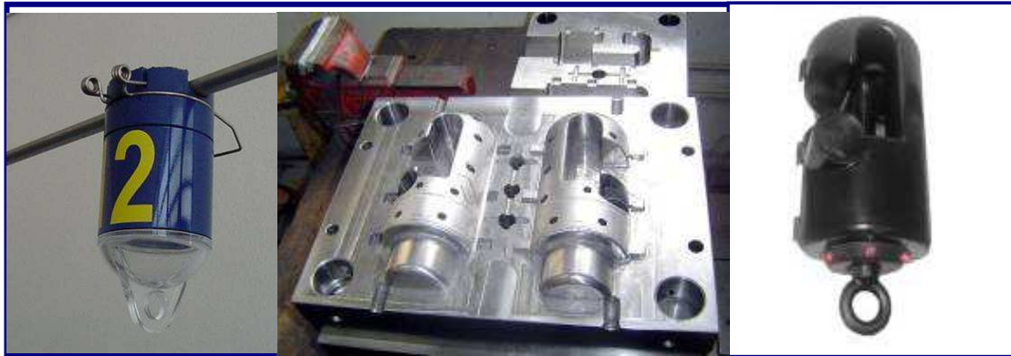
FIGURA 5 - Sensor de falta. Exemplo da fase de cabeça-de-série e lote pioneiro na evolução do invólucro e das funcionalidades de visualização e de instalação com vara de manobra. Proposta de fabricação comercial com molde de plástico injetável.
