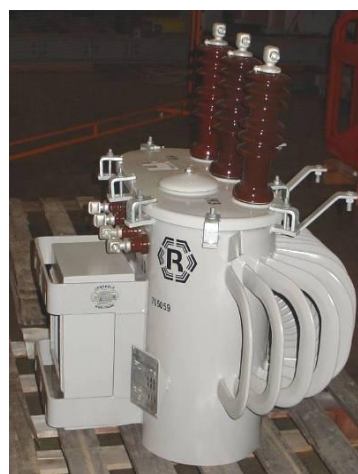
Figura 6 – Detalhe do protótipo montado do transformador com medição integrada
