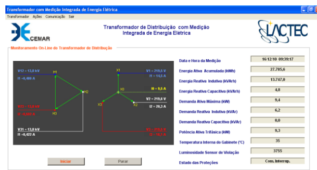
Figura 18 – Grandezas Monitoradas em Tempo Real pelo Transformador com Medição Integrada
