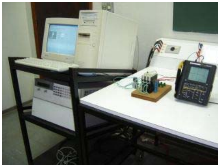
FIGURA 2 - Montagem dos ensaios de laboratório para análise de desempenho do contator ac
