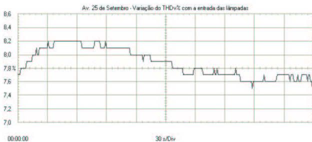
Figura 31- Variação do THD v % após a entrada das lâmpadas no transformador de IP da Trav. 25 de Setembro.
