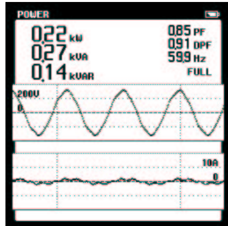
Figura 5- Lâmpada a vapor de sódio de 250W - potências ativa, aparente e reativa, fator de potência e fator de deslocamento.
