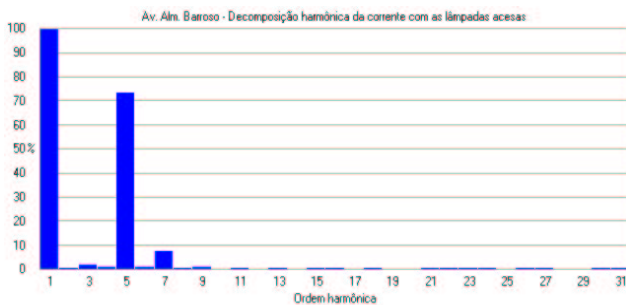
Figura 20- Espectro harmônico de corrente obtido após as lâmpadas de iluminação pública entrarem em regime.
