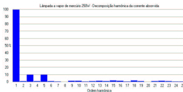
Figura 10- Lâmpada a vapor de mercúrio de 250W – espectro harmônico de corrente.
