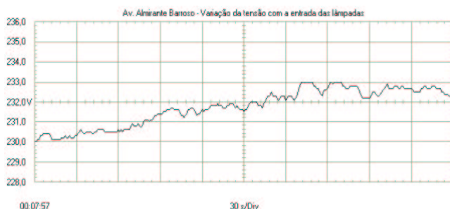
Figura 26- Variação da tensão RMS com a entrada das lâmpadas no transformador de IP da Av. Almirante Barroso.
