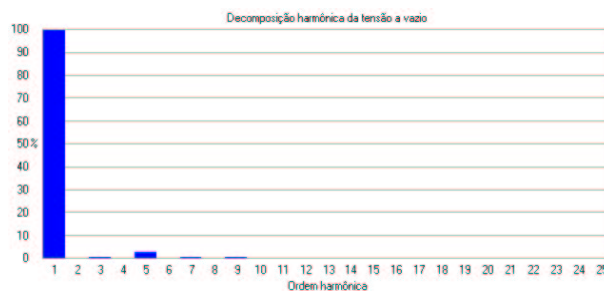
Figura 1- Decomposição harmônica da tensão de alimentação das lâmpadas a vazio.
