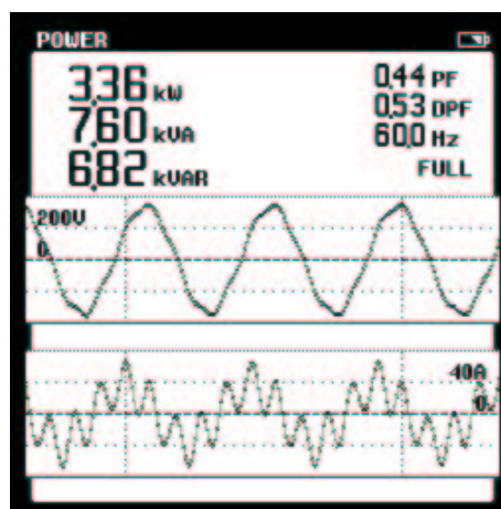
Figura 18- Av. Almirante Barroso – potências ativa, aparente e reativa, fator de potência e fator de deslocamento.
