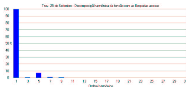
Figura 29- Espectro harmônico da forma de onda da tensão, com as lâmpadas acesas. A corrente tinha a forma de onda apresentada na figura 27.
