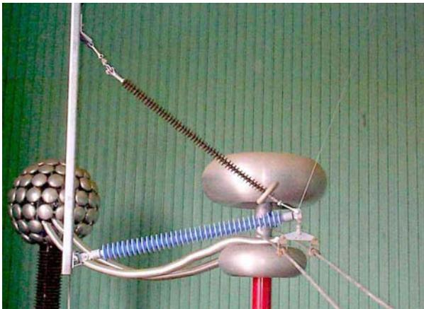
Figura 3 – Ensaio de Corona Visual e TRI
