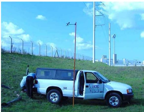
Figura 8 – Medições de Ruído Audível Sob os Condutores
