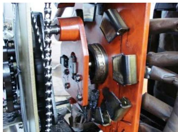
Foto 04 – RT com contatos internos desgastados. Foram substituídos.
