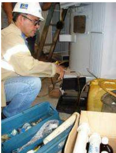
Foto 05 – Coleta de amostras de óleo para ensaios.
