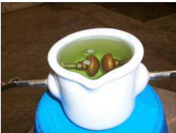
Figura 2 – Cuba com OVI para ensaio de impulso de descarga AC.
