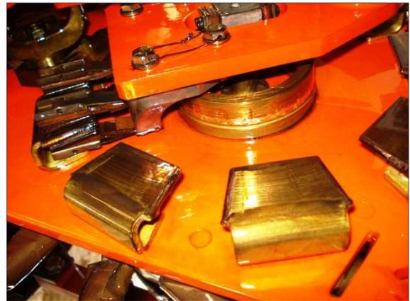
Foto11 – Contatos - Pólo com mistura 25V75M.
