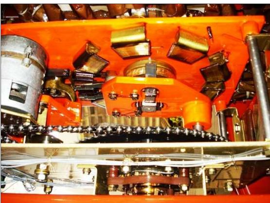
Foto 10– Contatos - Pólo com mistura 75V25M.
