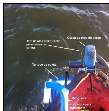
Figura 9. Fotografia da vista parcial do tanque de coleta de águas contaminadas a partir da proa da embarcação em operação em mar aberto.
