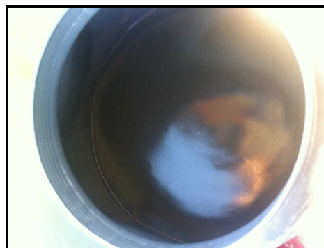
Figura 10. Fotografia registrando a finíssima camada de óleo lubrificante formada na superfície livre da água no tanque de coleta na proa da embarcação
