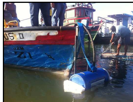
Figura 8. Arranjo para coleta de água contaminadas por óleo após ajustes preliminares na embarcação.
