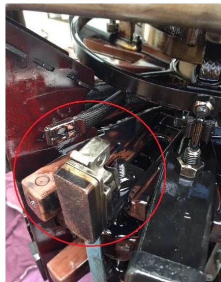
Figura 6. Resistência que segura o contato do comutador aberta.
