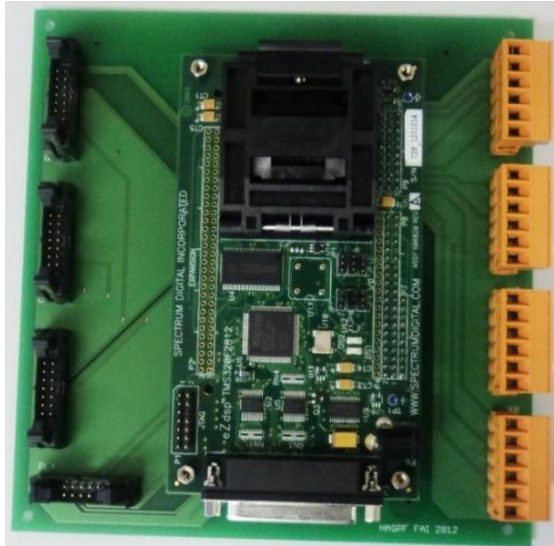
Figura 5. Placa de conexão entre o DSP e os demais circuitos eletrônicos.
