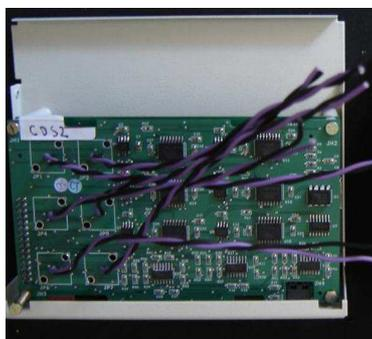
Figura 12. Base do gabinete com as duas PCIs já parafusadas e com os cabos de sinal.
