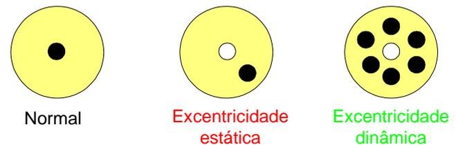
Figura 2. Tipos de excentricidade (o círculo branco representa o centro estatórico e o círculo negro, o centro rotórico).
