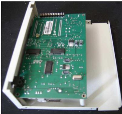
Figura 11. Posicionamento da placa digital no gabinete.
