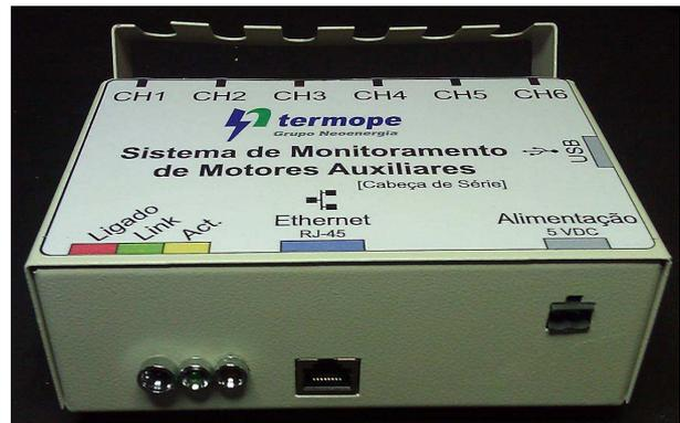
Figura 14. Gabinete fechado com as placas, “leds” e adesivo de identificação.
