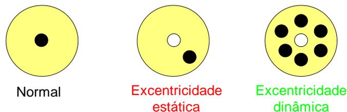
Figura 2. Tipos de excentricidade (o círculo branco representa o centro estático e o círculo negro, o centro rotórico).
