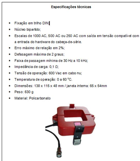
Figura 14. Especificação do transdutor de corrente para medição direta nas fases dos motores.
