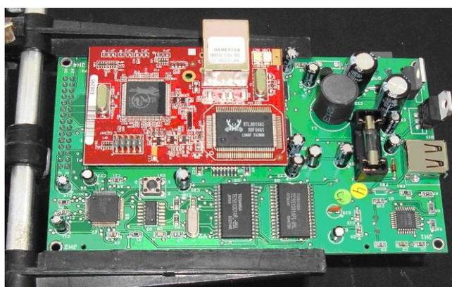
Figura 11. Placa do circuito digital acoplada à placa do módulo microcontrolador – vista inferior.
