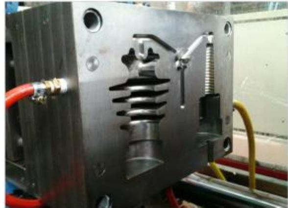
Figura 1 - Vista da Parte 1 do molde colocado na injetora. Lado esquerdo - corpo do isolador com saias. Lado direito - base do isolador.
