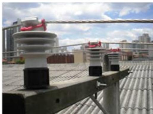
Figura 8 - Três unidades de isoladores protótipos instalados, fixação do cabo com anel elastomérico.
