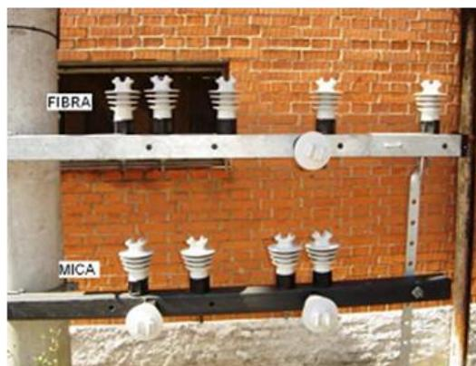
Figura 9 - Unidades de isoladores protótipos instalados ao tempo.
