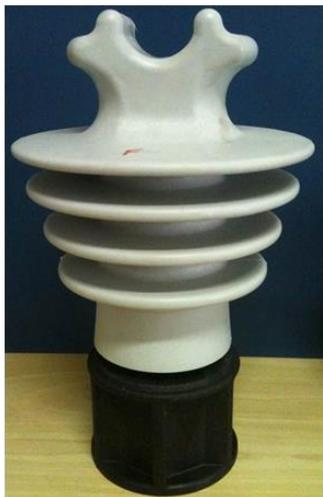
Figura 5 - Vista do corpo e base do isolador, acoplados.
