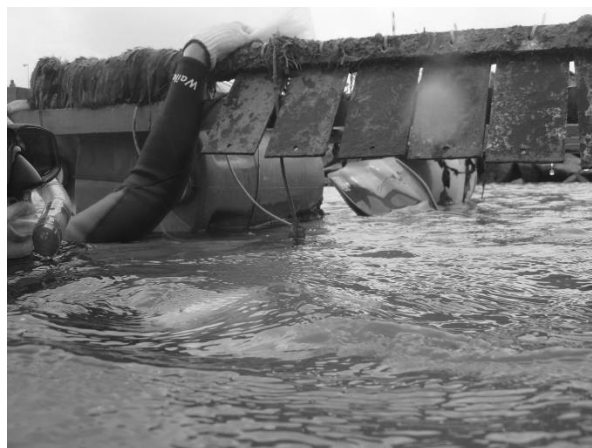
Figura 2. Placas de testes de substrato sendo testadas no canal de captação de água da TERMOPE.
