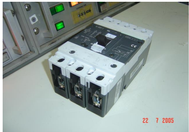
Figura 7. Foto do Disjuntor de BT
